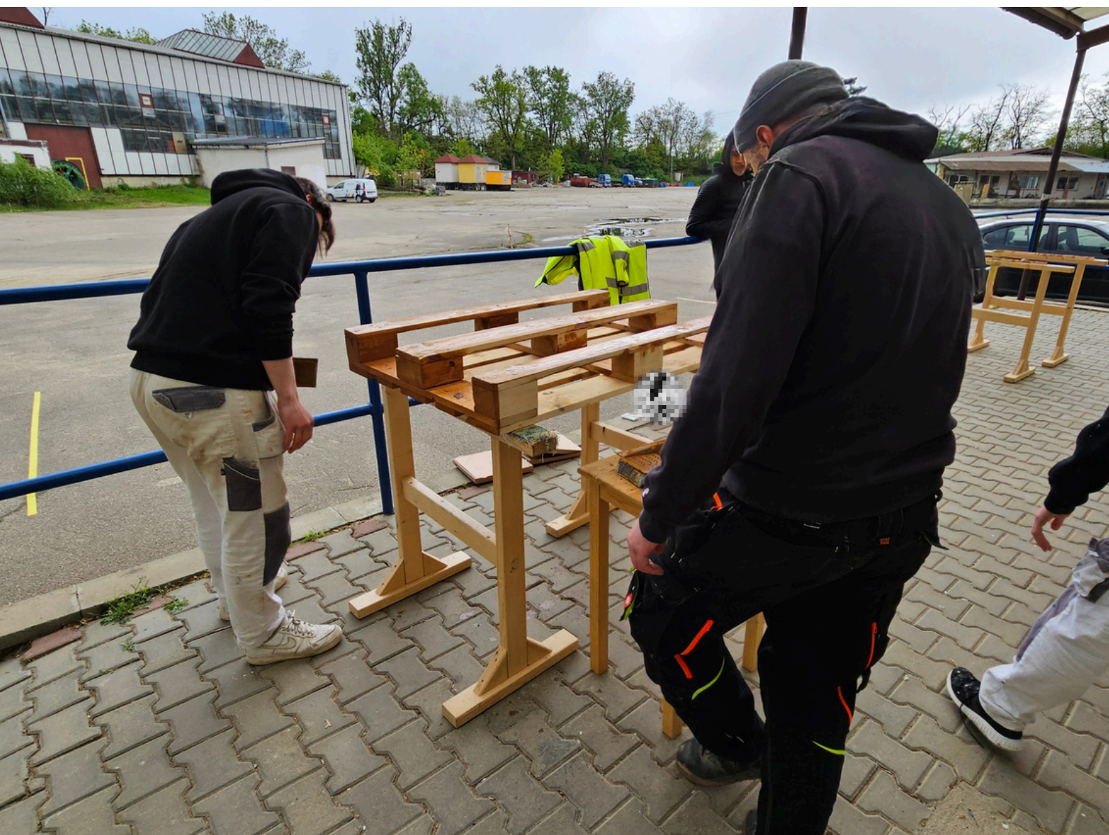
Obr. 16, 17 - Kompletace nanečisto, kdy jsme si vyzkoušeli v praxi dva různé designy paletového posezení - 3 palety o výšce o 3 palet, 3 palety o výšce 2 palet. Stoly budou také řešeny "půl na půl", kdy jeden stůl bude vysoký 3 palety, druhý vysoký 2 palety.
